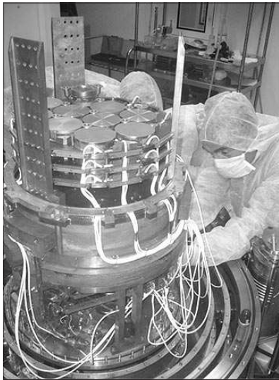
Установка детекторов в криостат.
