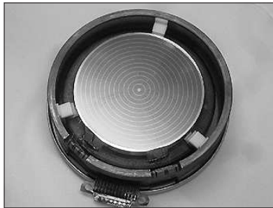
Один из уникальных HPGe детекторов, используемых для поиска частиц темной материи в эксперименте EDELWEISS-II.
