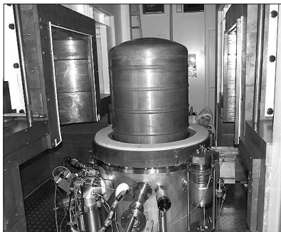
Криостат растворения, внутри которого находятся HPGe детекторы при температуре в 20 мК.
