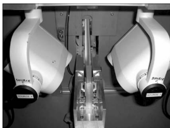
Рис. 3.77. Слева: измерительный узел прибора для определения положения нити относительно оси трубки (на базе рентгеновских трубок и рентгеночувствительных CCD-матриц). Справа: результаты измерения координат анодной проволоочки в собранных детекторах. Из [237]
