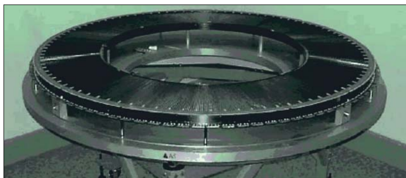
Рис. 3.10. Общий вид кольцевого субмодуля TRT типа В со всеми строу-трубками. После сборки субмодули объединялись в восьмислойные модули с установкой в них всех элементов сервисных систем. Из [60, 62]
