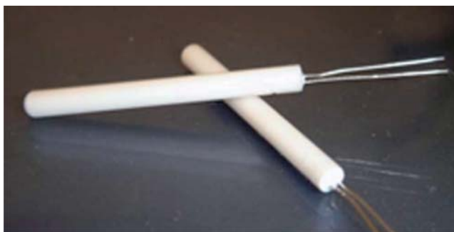
Рис. 3.66. Платиновые термометры PT100, которые используются в эксперименте ATLAS
