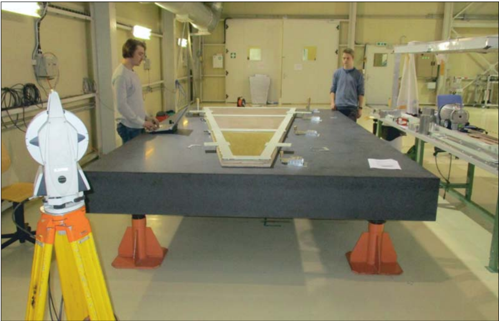
Рис. 3.49. Юстировка реперных точек сборочного стола сектора нового детектора New Small Wheel
