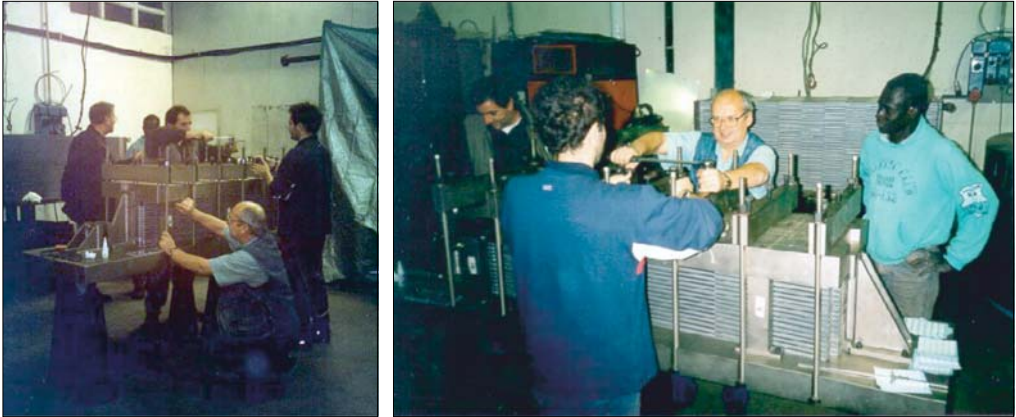
Рис. 3.18. Н. Д. Топилин проверяет качество сборки (слева) и склейки (справа) субмодулей тайл-калориметра на специализированной фирме в Пизе. Фото Tarcisio Del Prete
