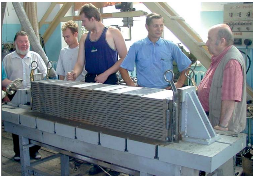
Рис. 3.29. Вверху: модуль — 1/64 часть всего барреля, содержит 19 субмодулей на балке (короткий модуль, соответственно, содержит 10 субмодулей), длина — 6,4 м (или 3,2 м), высота 1,95 м, масса 20 т (или 10 т). Внизу: субмодуль, склеенный из 32 мастерных и 200 спейсерных пластин, длина — 1,6 м, толщина 291,7 мм (или 341,2 мм), масса почти 900 кг
