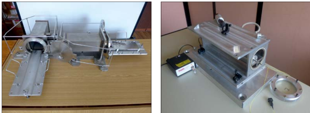
Рис. 5.7. Прецизионный лазерный инклинометр. Январь 2017 г.
