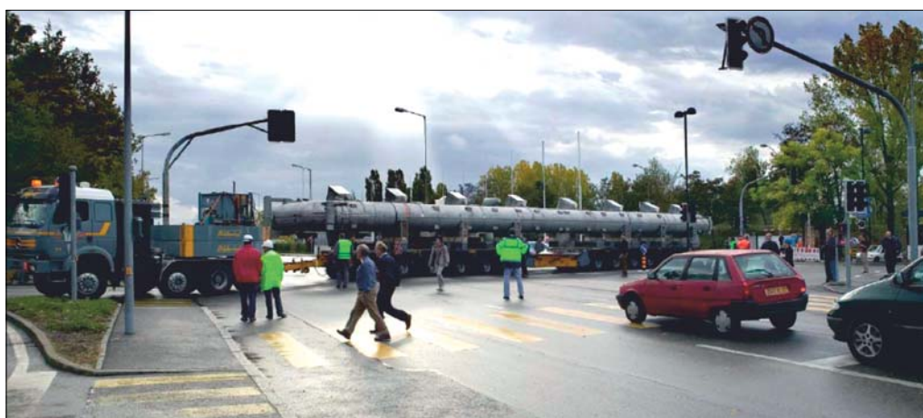
Рис. 3.112. Первая катушка магнитного тороида на пути к месту расположения эксперимента ATLAS. 21 октября 2004 г.
