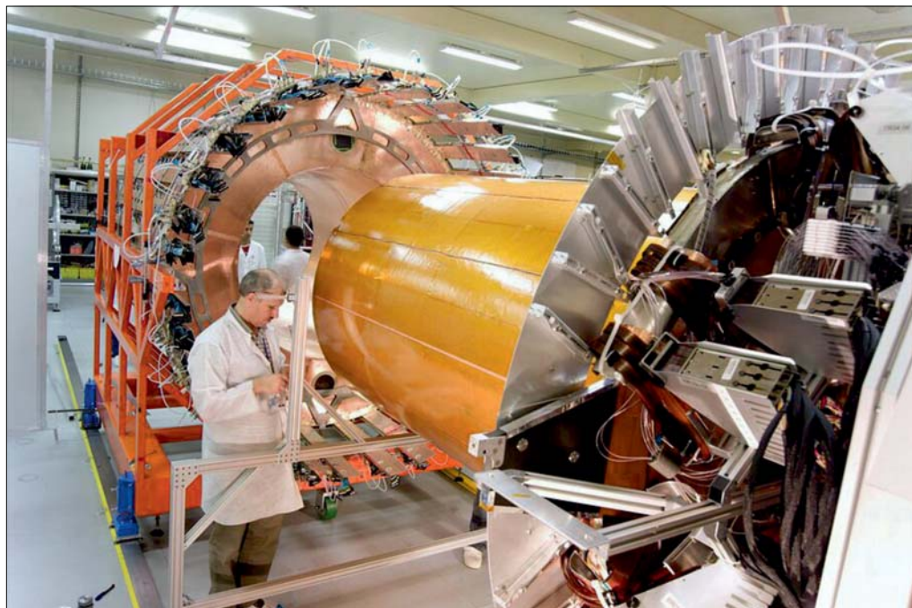
Рис. 3.13. Процесс интеграции детекторов End-Cap A
