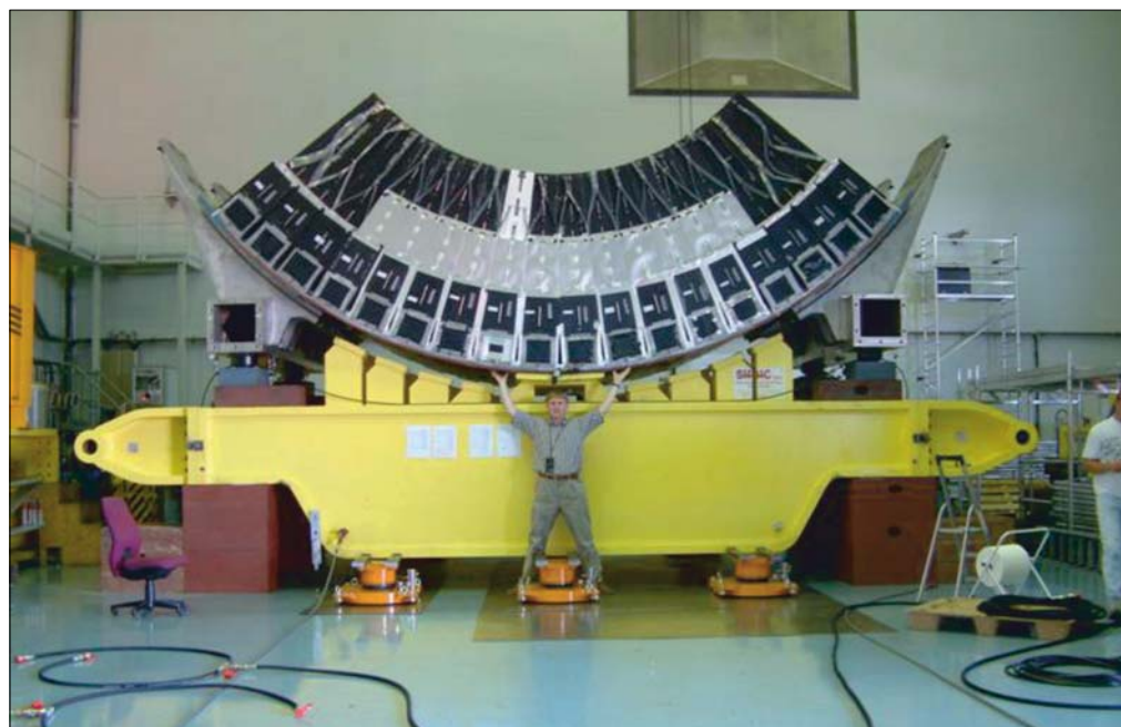
Рис. 3.30. Этапы предварительной сборки первого короткого (торцевого) барреля (из барселонских модулей) на поверхности
