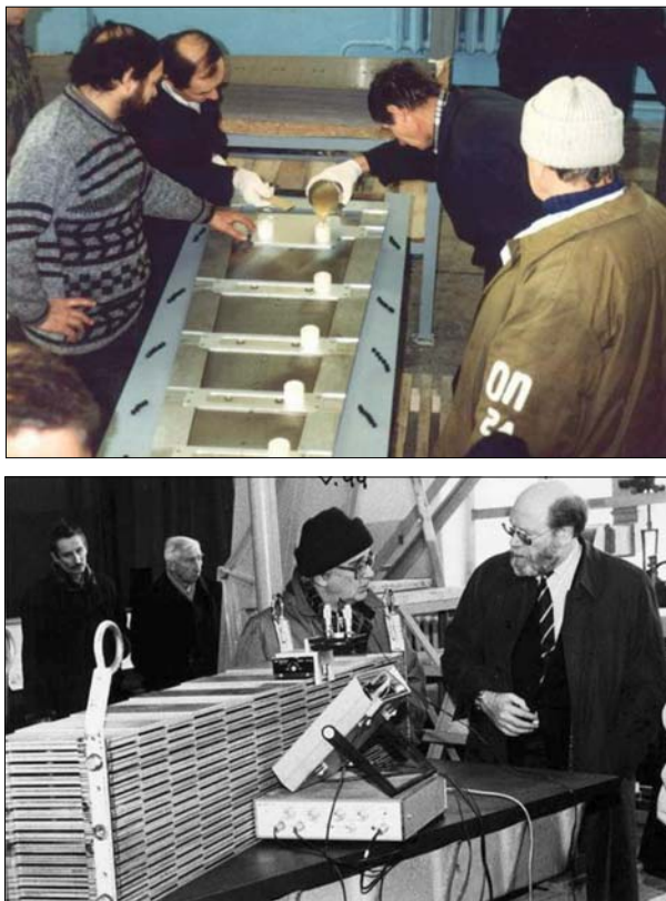
Рис. 3.22. Вверху: склеивание мастерных и спейсерных пластин в submodule путем дозированного нанесения клея (способ предложен В. М. Романовым). Внизу: контроль высоты submodule на поворачивной плите
