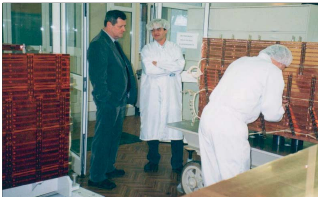
Рис. 3.56. Сборка модулей LAr-калориметра ATLAS шла в чистой комнате ЛЯП. Вверху: вид собранного модуля. Внизу: Н. А. Русакович и М. Ю. Казаринов в чистой комнате
