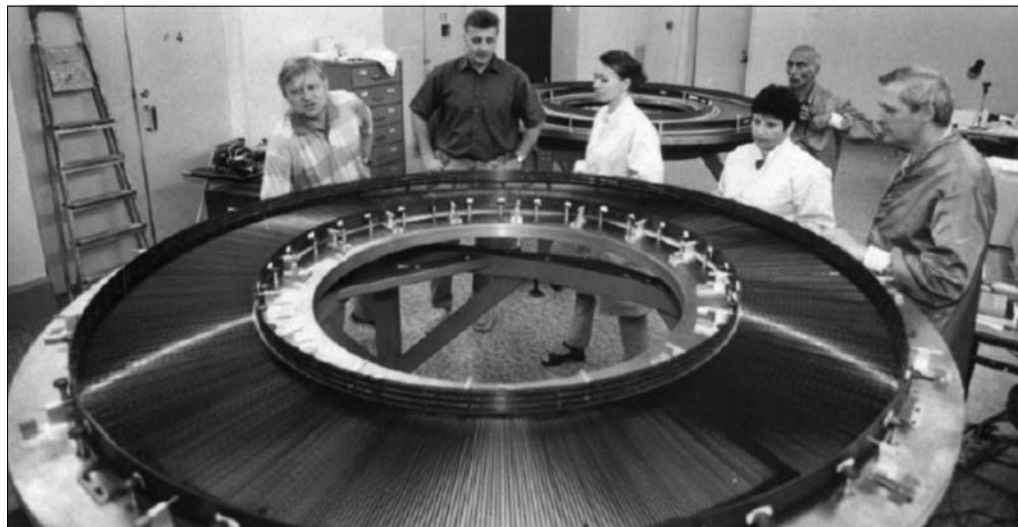
Рис. 3.9. Первое кольцо внутреннего трекера в режиме массового производства
