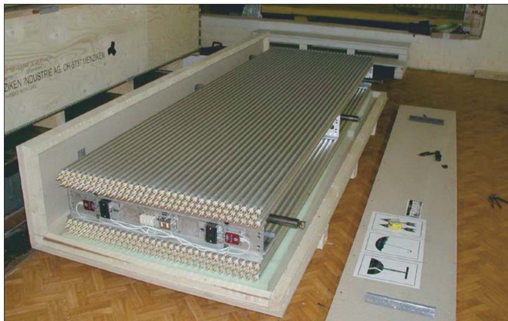
Рис. 3.84. Дрейфовая камера BMS-типа, готовая для отправки в ЦЕРН
