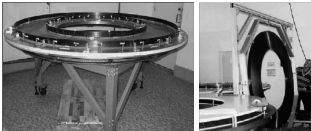
Рис. 3.11. Слева: стол для сборки субмодулей с установленными композитными кольцами. Справа: транспортное устройство для надежного перемещения субмодулей.
