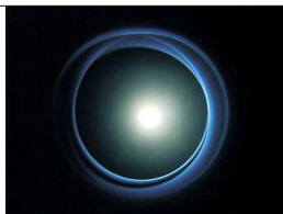
Фотография двухконусного излучения Вавилова–Черенкова, полученная на пучке ядер свинца с энергией 157 ГэВ/н ускорителя SPS в ЦЕРН, размещенная на обложке журнала CERN Courier (декабрь 1998).
